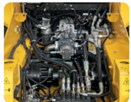
La cabine inclinable peut être soulevée en quelques minutes pour ouvrir l'accès au distributeur et aux principaux composants hydrauliques
