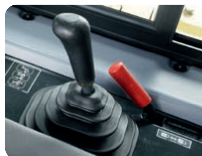
Leviers de verrouillage de sécurité
