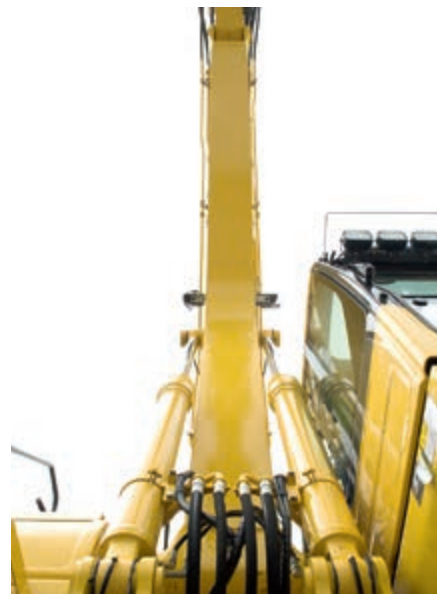
Pièces de la flèche uniques moulées
