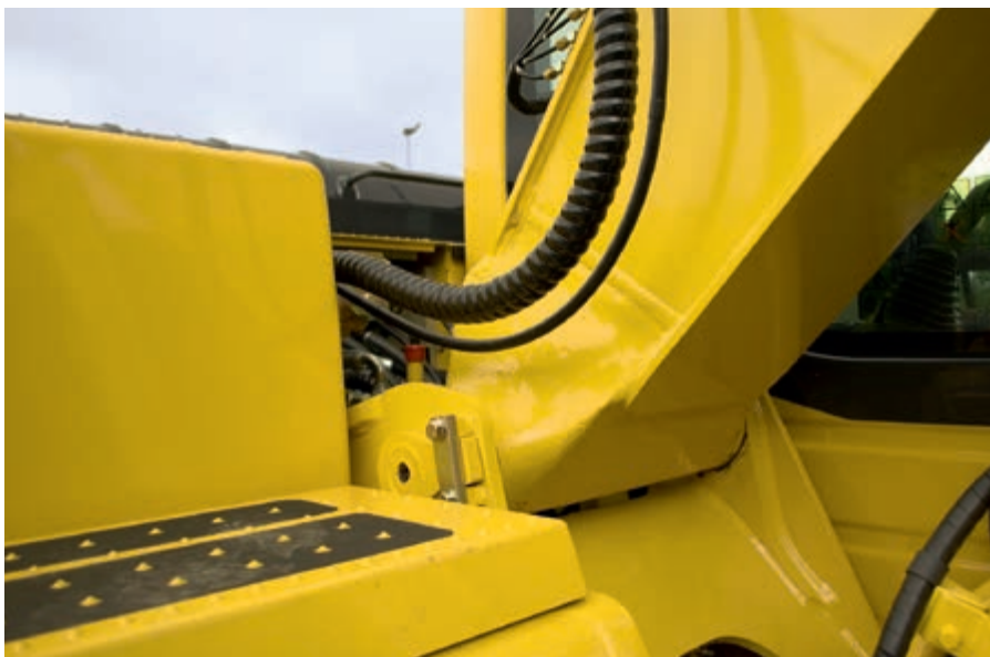
Pied de la flèche en acier moulé
