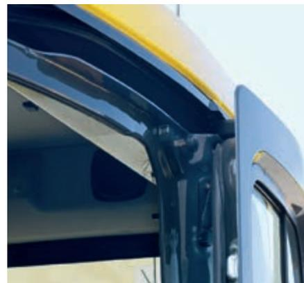
*Les portes coulissantes permettent un accès aisé à la cabine dans les endroits exigus et réduisent le risque d'endommagement sur les routes. La porte de la cabine a aussi une vitre coulissante.*
