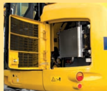
Les grilles de radiateurs intégrées dans les capots latéraux facilitent le nettoyage depuis le sol.
