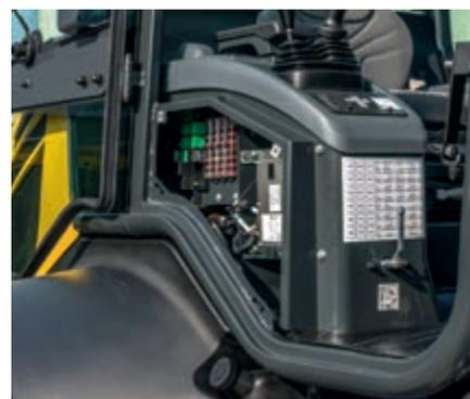
*Capot latéral pour un accès facilité lors de la maintenance et nettoyage intérieur*
