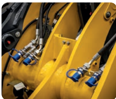
Haut débit pour 3e circuit auxiliaire (160 l/min à 220 bar)
