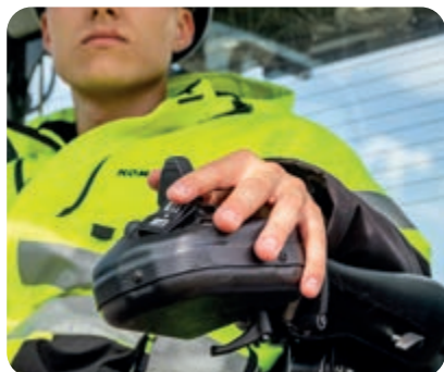
Direction à manipulateur court Komatsu (K-SLS) (option)
