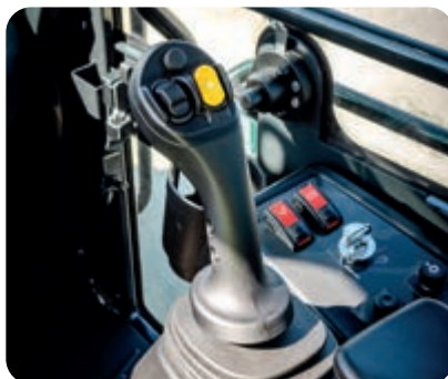
Manipulateur multifonctions PPC à contrôle électronique pour le 3e circuit hydraulique auxiliaire
